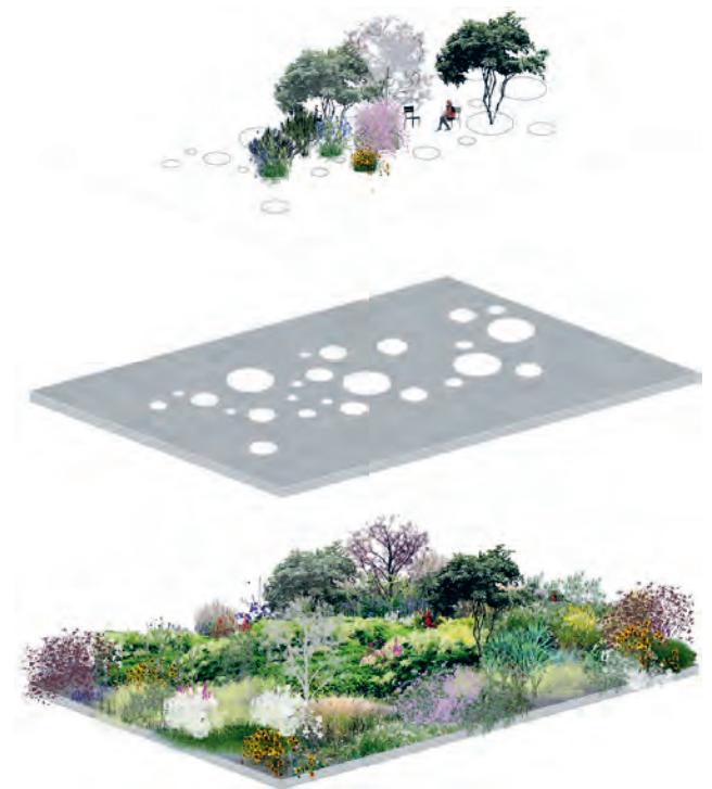
Das Büro Krebs und Herde hat den mit Sickerasphalt überzogenen Boden mit kreisförmigen Öffnungen perforiert. Daraus quillt üppige Stadtnatur.
